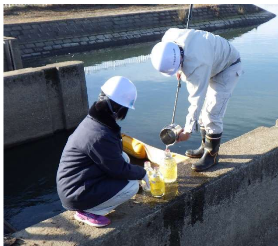
取水口の採水作業
