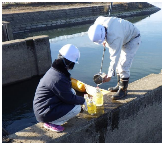
取水口の採水作業
