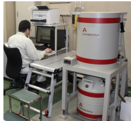
放射性物質検査(ゲルマニウム半導体核種分析装置)
