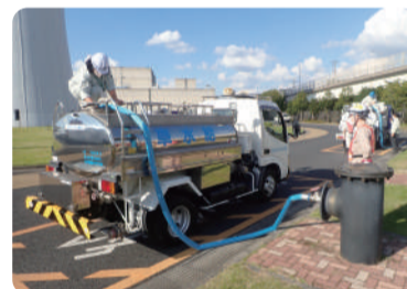
応急給水栓から給水車への充水
