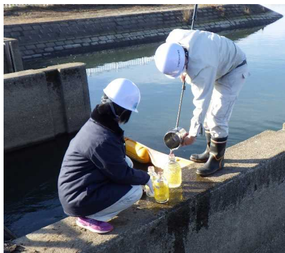
取水口の採水作業
