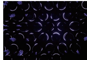
オゾン発生装置放電の様子
