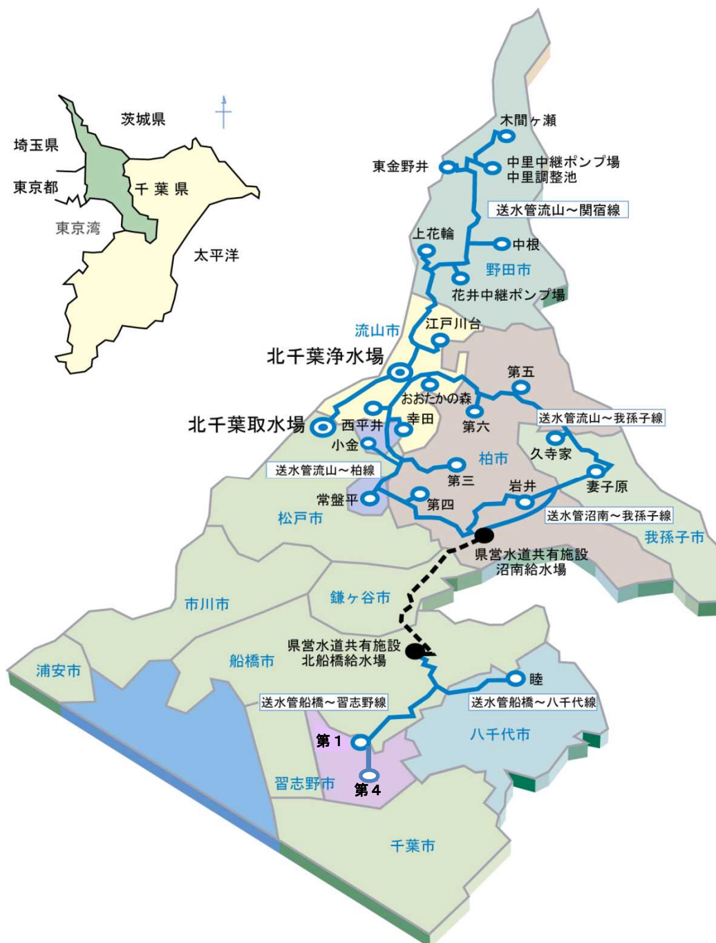
図2-1-1 北千葉広域水道企業団 水道システム概要図
