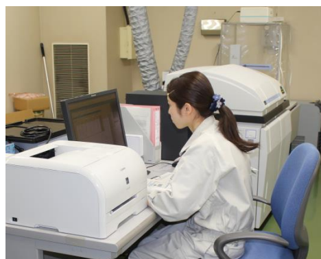
金属類検査(誘導結合プラズマ質量分析装置)
