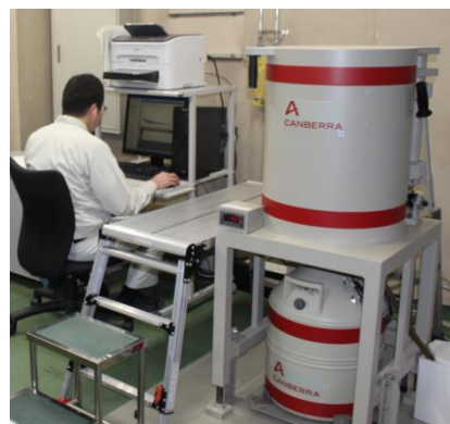
放射性物質検査(ゲルマニウム半導体核種分析装置)
