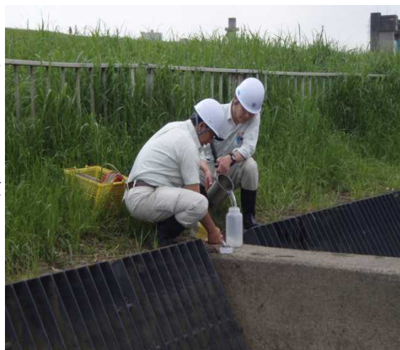
取水口の採水作業
