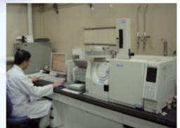
ガスクロマトグラフ質量分析装置による水質検査 (トリハロメタン、カビ臭物質等の測定)
