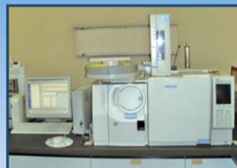
ガスクロマトグラフ 質量分析計 トリハロメタンやカビ臭物質濃度を測定しています。
