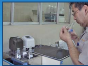
におい・味の検査 1日6回4時間おきに異常の有無を確認しています。
