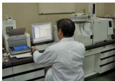
ガスクロマトグラフ質量分析計 ホルムアルデヒド等の測定
