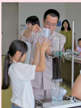
水道水を作る実験 川の水をきれいにするために、薬品を入れたり、かき混ぜたりします。その上澄みの水を砂でろ過して消毒するための薬品を入れました。
